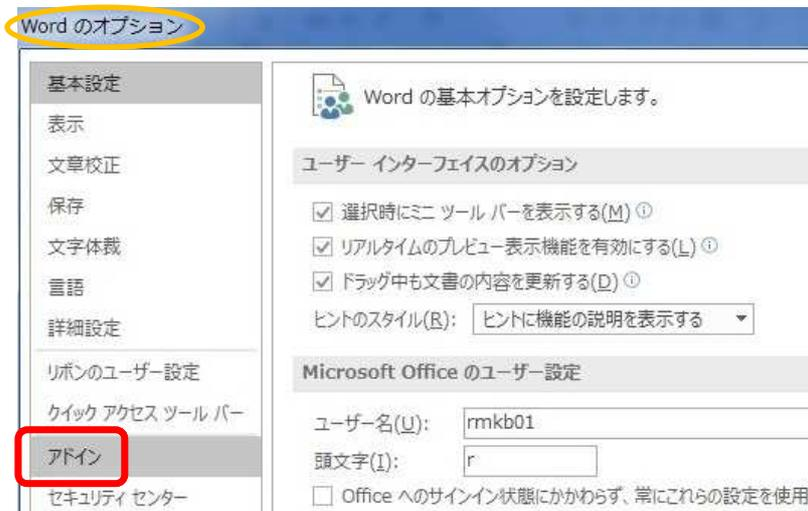
4. 「Microsoft Office のアドインの表示と管理を行います。」の窓が開きますので一番下にある、管理 (A) : [COM アドイン] 右側の①小さな下向▼をクリックし、プルダウンの②「使用できないアイテム」を選択、③ [設定] をクリックします。
